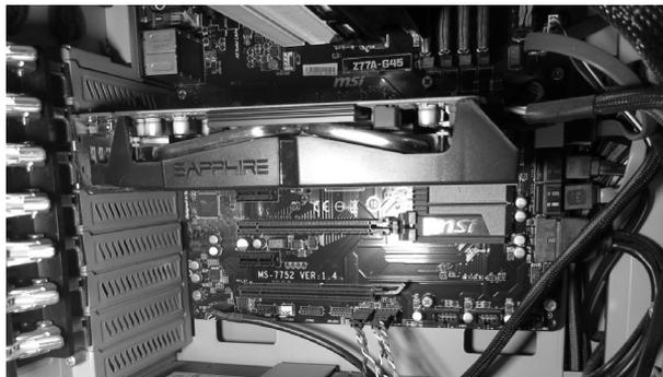
Très souvent, les prises sur les cartes disposent de **six broches**, tandis que les câbles disposent de **huit broches**, avec une prise **six broches** et une seconde de **deux broches**. Il suffit de laisser pendre les deux broches en trop.
