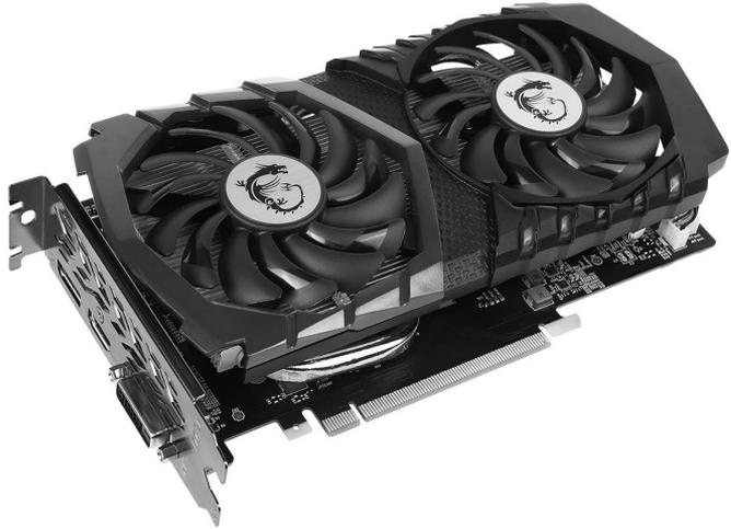
Il suffit alors d'insérer les connecteurs de la carte dans l'emplacement sur la **carte mère**. Un petit loquet devrait alors se clipser pour la maintenir en place, comme avec la **mémoire vive**. Il faut alors placer une (ou deux) vis sur la partie métallique de la carte qui remplace le cache.
