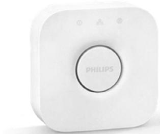
*Boîtier Philips Hue autrement appelé « pont ». Connecté directement à la box internet domestique et aux ampoules, il permet de les contrôler à distance à l'aide d'un téléphone portable.*
