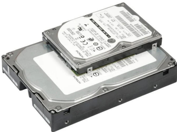
Comparaison d'un disque dur 3,5 pouces (en dessous) et 2,5 pouces
